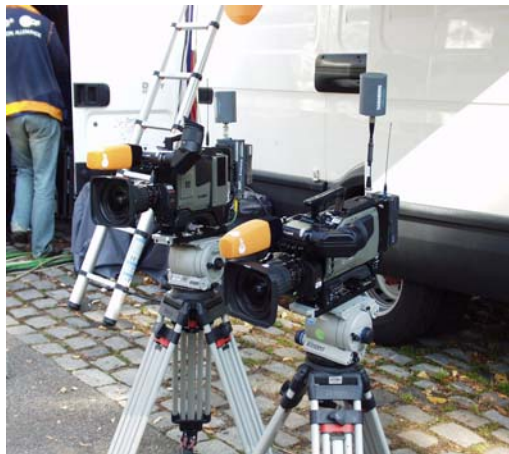
drahtlose Kameras im 2,3 GHz-Bereich
