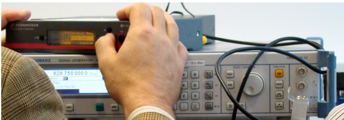
Mikrofonempfänger (DUT) und ein Messgenerator als Mikrofonnachbildung
