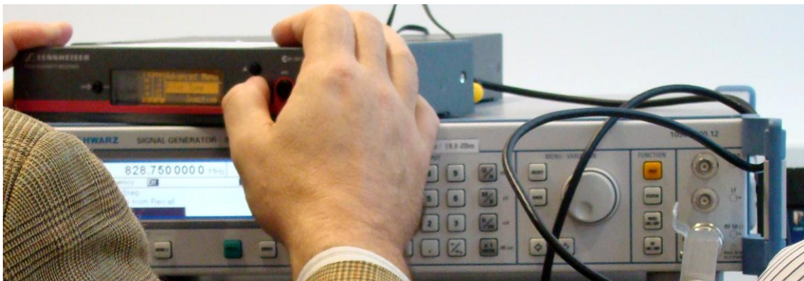
Mikrofonempfänger (DUT) und ein Messgenerator als Mikrofonnachbildung
